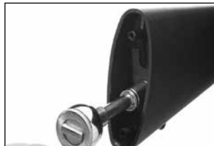
Используйте торцевой гаечный ключ, чтобы извлечь из приклада винт
