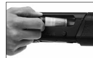
Вставьте патрон через выбрасыватель в затворе
